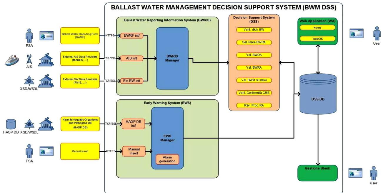
**Fig. 2: BWM DSS block diagram.**
