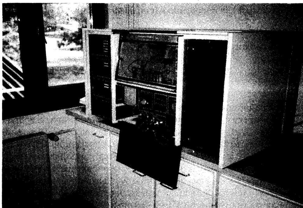
Slika 3. Analizator sladkorjev Biotronik HPLC 5001 v Laboratoriju za kemijo lesa na Biotehniški fakulteti, Oddelek za lesarstvo v Ljubljani (foto GORNIK)
