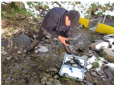
Slika 35. Meritve kakovosti vode v potoku s prenosnim merilnim inštrumentom HQ40d Multi meter (HachLange). (Foto Urša Vilhar)
