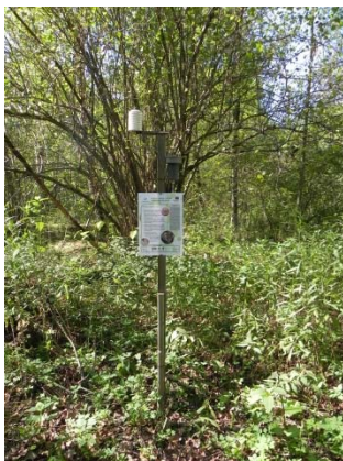
Slika 36. Avtomatski merilniki na monitorinški lokaciji Gameljne – Tacen, raziskovalna ploskev P2 (topol), za kontinuirane meritve temperature zraka na višini 2 m, vsebnosti vlage v tleh in temperature tal na globini 0,1 m in 0,3 m. (Foto Urša Vilhar)
