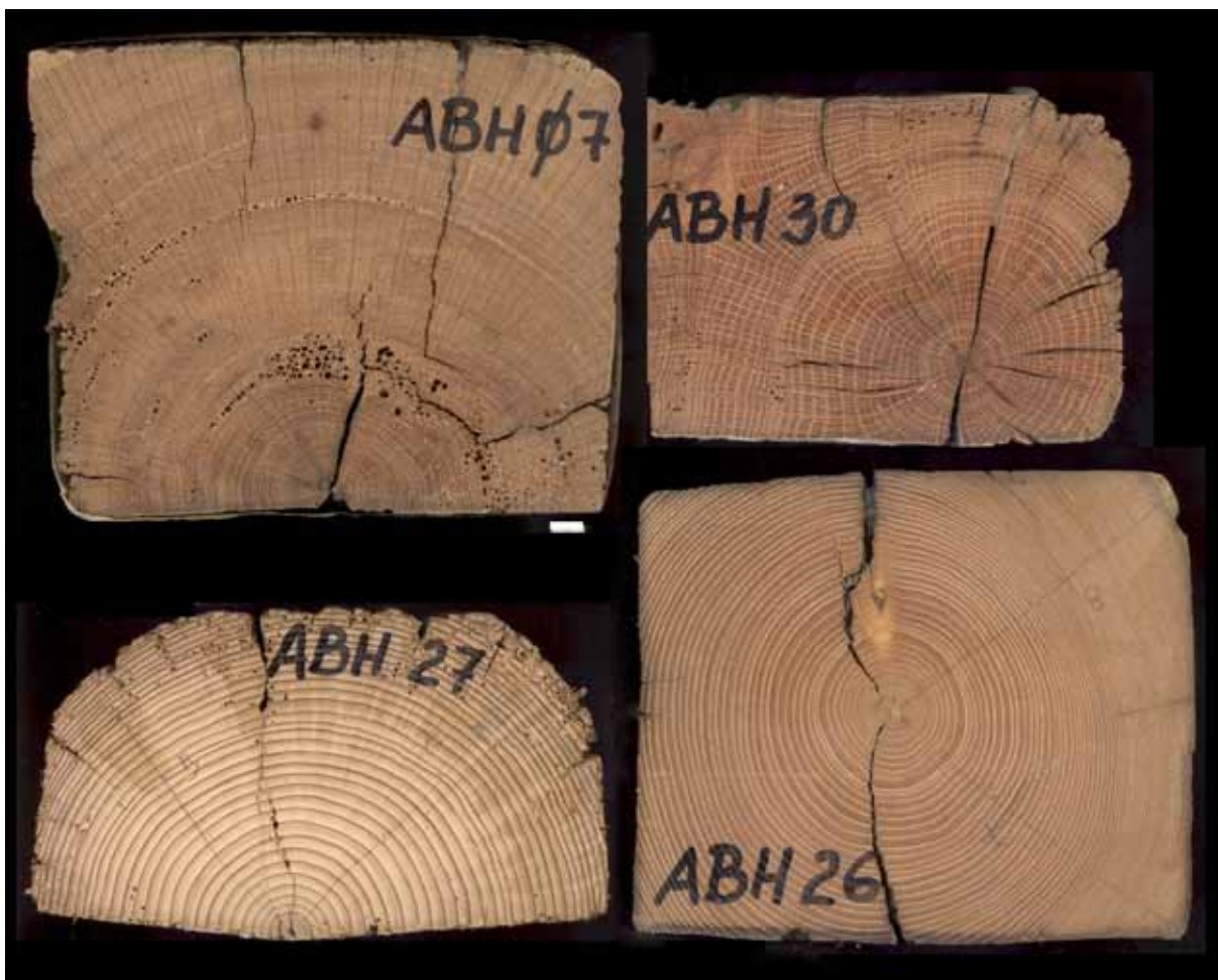
Slika 5: Gradbeni les z izjemno ozkimi branikami in 30 branikami beljave zgoraj levo (ABH 07), cer z izjemno širokimi branikami v osrednjem delu (ABH 30), smreka z majhnim številom razmeroma širokih branik (ABH 27) in kostanj z dvema branikama beljave zgoraj desno (ABH 26). Merilna daljica 1cm (foto K. Čufar 2012)
