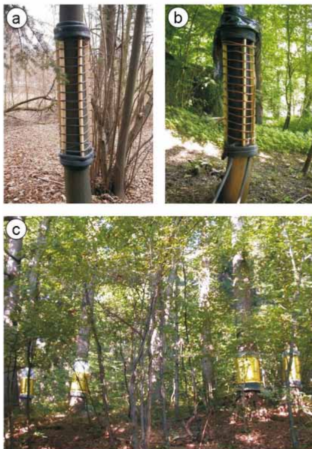
Slika 1: a) Grelni sistem, nameščen na delu debla javorja. Grelni kabel je ovit okoli debla in distančnikov, tako da ni neposredno na skorji (foto: Š. Jagodic, 2008); b) Hladilni sistem, nameščen na delu javorjevega debla. Za hlajenje so uporabljene bakrene cevi, napolnjene z vodo (foto: Š. Jagodic, 2008); c) Postavljena in izolirana grelna in hladilna sistema na odraslih hrastih (foto: Š. Jagodic, 2007).
