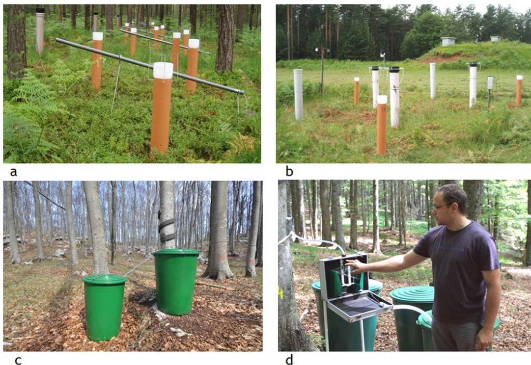
Slika 4: Fotografije: a - vzorčevalnik sestojnih padavin in b - vzorčevalnik padavin na prostem (obe Brdu pri Kranju); beli liji so harmonizirani vzorčevalniki; c - vzorčevalnik odtoka vode po deblu in d - demonstracija avtomatskih meritev (obe Tratice na Pohorju)
