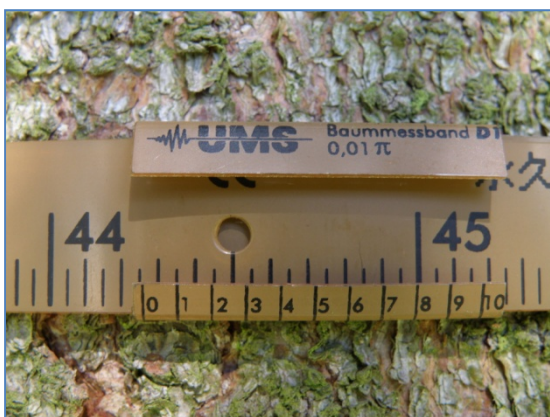
Slika 6: Spremembe v premeru debla odčitavamo na desetinko milimetra natančno. To nam omogoča nonijska skala. Drevo na sliki ima na primer premer 44,25 cm.
