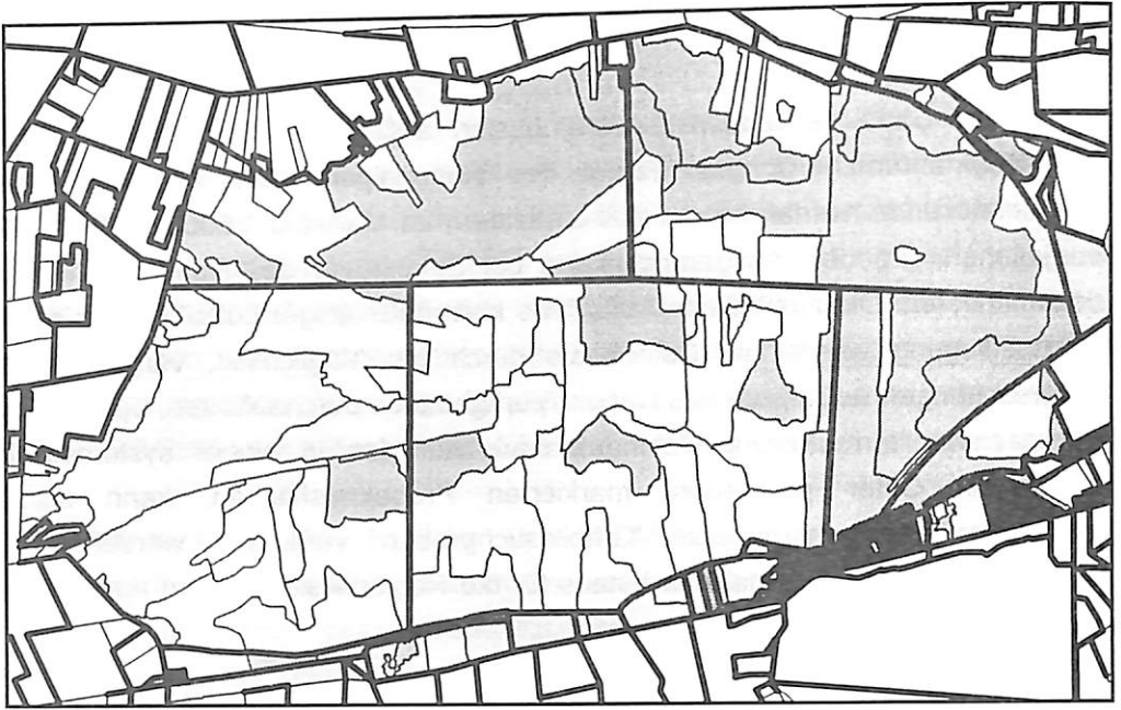
Fig. 2: Differenzierung von Flächenobjekten des ATKIS mit Hilfe der analytischen Luftbildauswertung (breite Linien = ATKIS DLM, schmale Linien = Auswertung von CIR-Luftbildern M 1:10000, Graustufen = Flächenobjekte der CIR-Luftbildauswertung)
