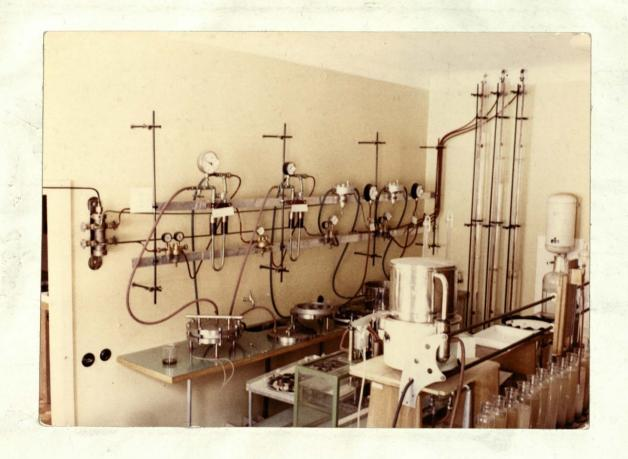
Del aparature za določanje vlage in poroznosti tal po Richards-u (izdelana v okviru te naloge)
