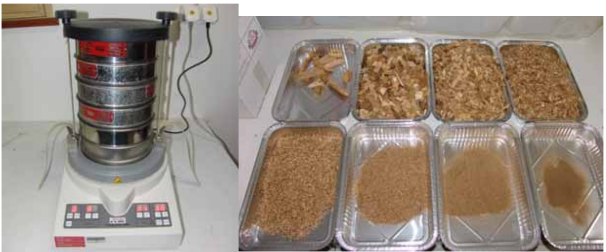
Slika 8 Stresalna naprava s siti za ugotavljanje porazdelitve velikosti lesnih sekancev in struktura sekancev po sejanju (GIS, 2009).
