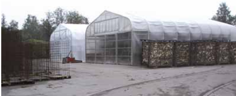
Slika 15 Zaprti prostor (podoben rastlinjaku) za sušenje cepanic, (Bavarska–Nemčija).
