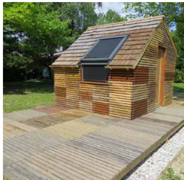
Slika 3: Modelni objekt za spremljanje življenjske dobe lesa in kvalitete toplotnega ovoja
