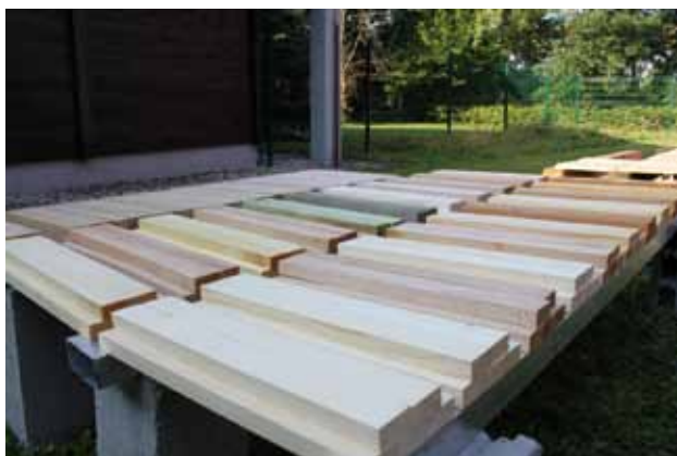
Slika 1: Terensko polje na Oddelku za lesarstvo, BF. Prikazan je dvoslojni test, za določanje življenjske dobe lesa v tretjem razredu uporabe
