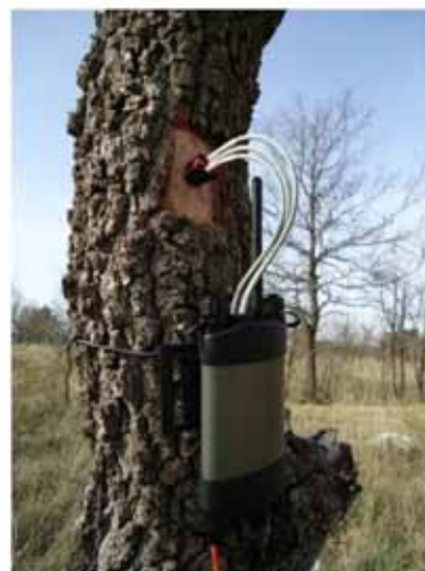
Slika 1: Razporeditev elementov pri HRM metodi (levo) (ICT International, 2014); SFM1 merilnik ksilemskega toka, nameščen na drevo (desno)
