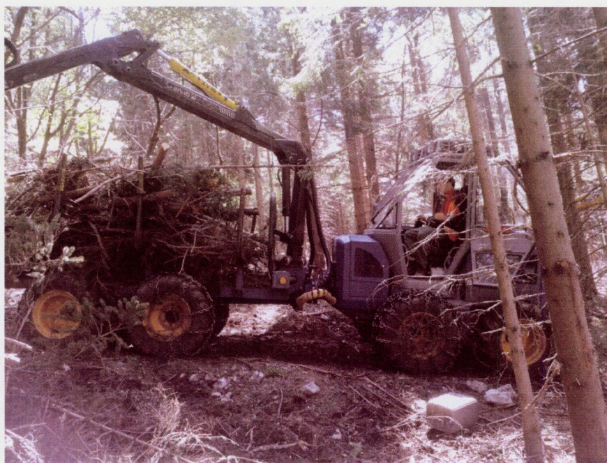
Slika 62: Zbiranje in izvoz sečnih ostankov z zgibnim prikoličarjem
