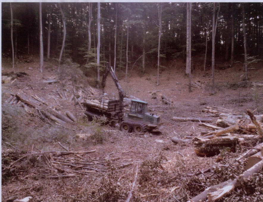
Slika 85: Izvoz okroglega lesa z zgibnim prikoličarjem (Trnovo)
