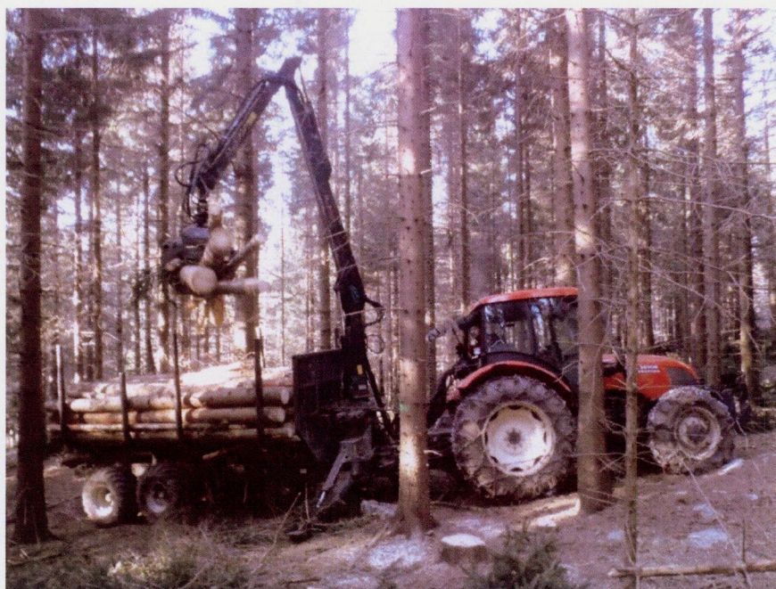
Slika 61: Izvoz okroglega lesa s traktorjem in gozdarsko prikolico
