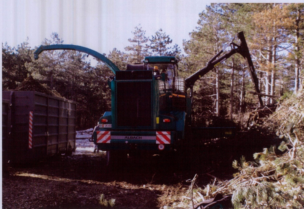
Slika 73: Izdelava sekancev iz sečnih ostankov
