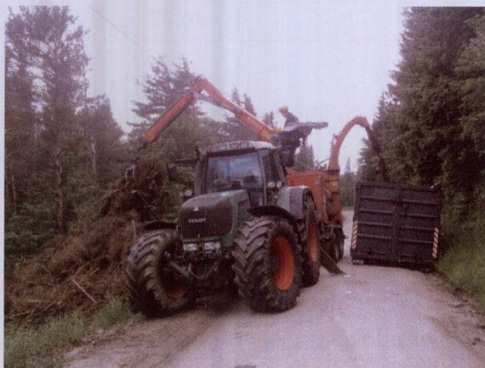
Slika 66: Izdelava sekancev ob gozdni cesti
