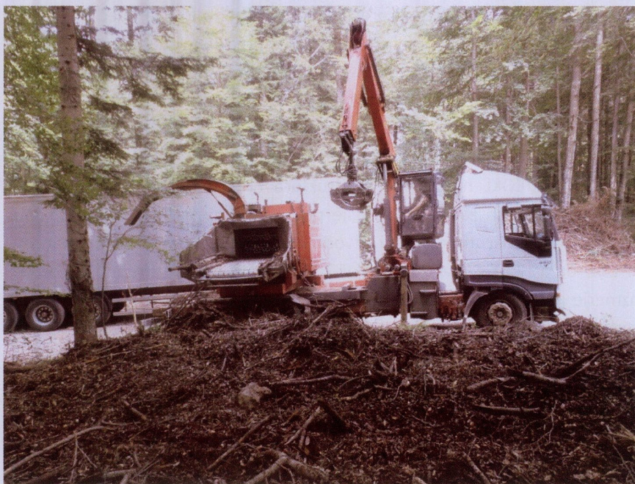
Slika 84: Izdelava sekancev iz sečnih ostankov na Trnovem
