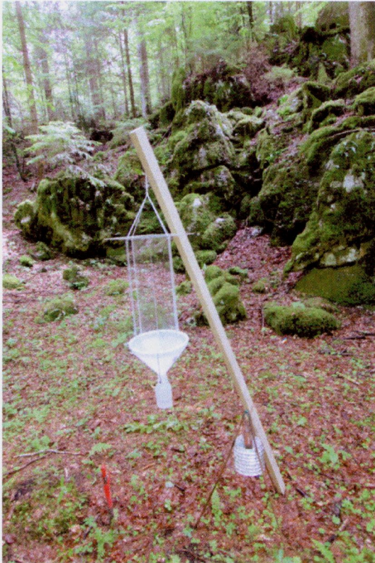
Slika 48: Okenska past za lovljenje muh trepetavk. Pod pastjo je temperaturni senzor s hranilnikom podatkov (foto. L. Kutnar).
