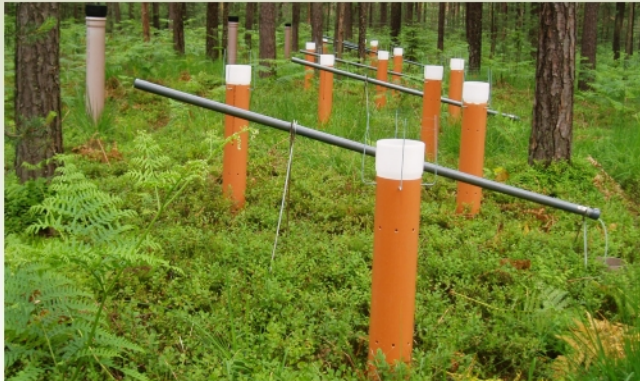
Meritve padavin v sestoji s t.i. nacionalnimi vzorčevalniki in harmoniziranimi EU vzorčevalniki – liji, oblikovanimi in proizvedenimi v Sloveniji / Foto: Daniel Žlindra
