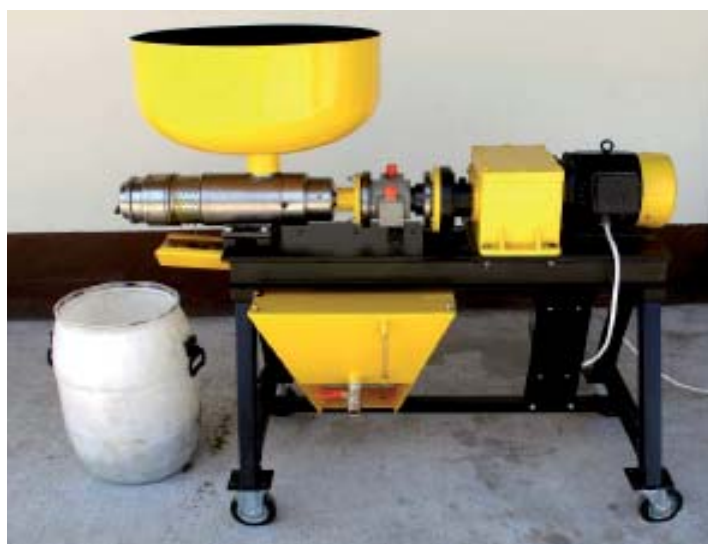
Stiskalnica za kontinuirano stiskanje semen oljne ogrščice; maksimalna kapaciteta stiskanja znaša 50 kg/h semen, odvisno od vrste semen; urni učinek se lahko podvoji s serijsko vezavo še ene stiskalnice
