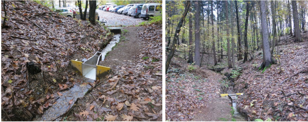
Slika 14: Preliv za meritve vodostaja na monitorinški lokaciji Rožnik (foto: Urša Vilhar)
