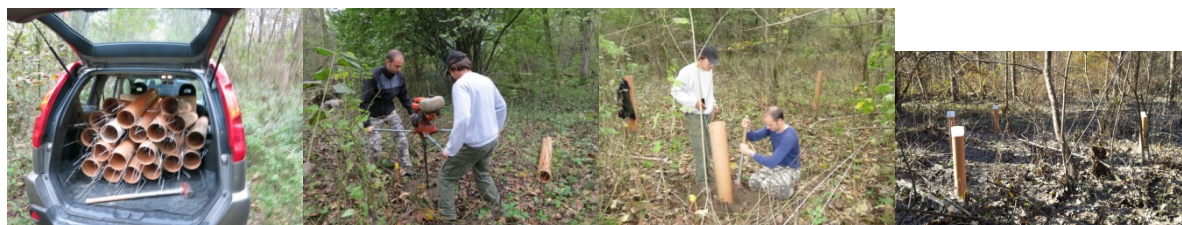
Slika 26: Postavitve vzorčevalnikov za depozite na monitorinški lokaciji Gameljne – Tacen (foto: Urša Vilhar)
