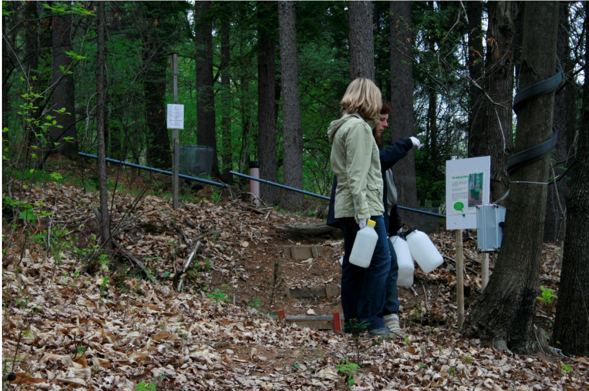
Slika 19: Spremljanje depozitov v padavinah na lokaciji Rožnik. (foto: Andrej Verlič)
