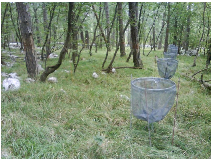
Slika 4: Prikaz postavitve lovilcev opada na raziskovalni ploskvi.
