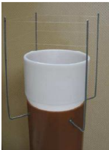
Fotografija 6: Vzorčevalnik za spremljanje depozitov v sestoji in prostem z zaščito proti ptičem (foto: D. Žlindra)
