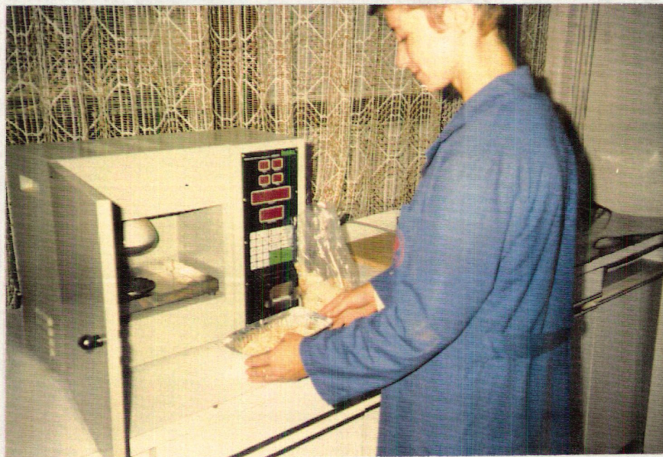
Slika 8: Zatehtan sto gramski vzorec žagovine je pripravljen za sušenje (Foto A. Žgajnar)
