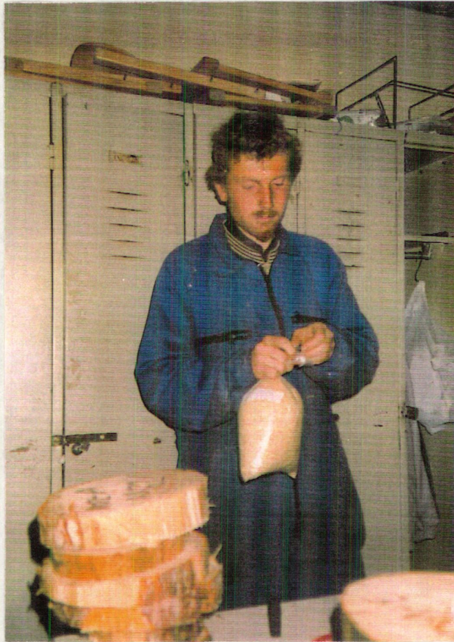
Slika 7: Priprava vzorca žagovine za analizo deleža suhega lesa (Foto A.Žgajnar)
