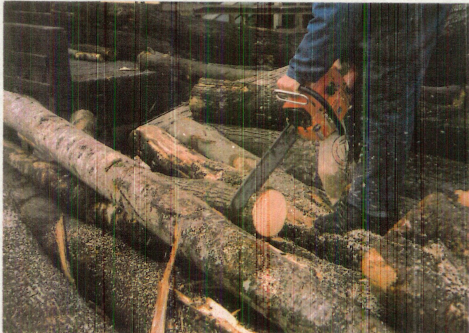
Slika 3: Jemanje vzorčnih kolobarjev za ugotavljanje volumenske mase in žagovine za dolčcanje vsebnosti suhega lesa (Foto A. Žgajnar)
