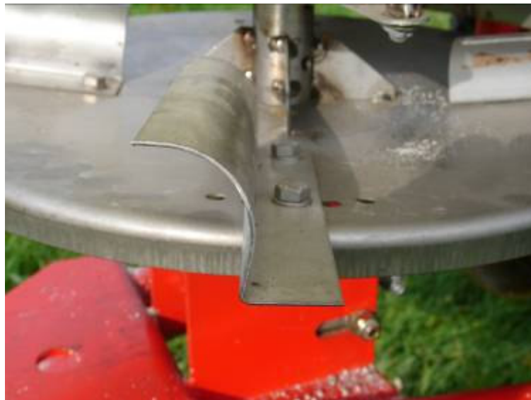
Slika 11: Nastavljive lopatice na krožni plošči trosilnika z eno ploščo
