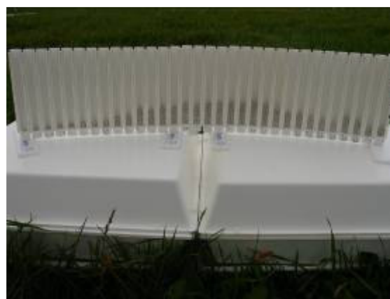
Slika 19: Slika trosenja prikazana s pomočjo epruvet v katere se nasuje gnojilo iz posameznih testnih posod.
