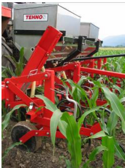
Slika 29: V zgodnji fazi rasti potrebuje korusa malo dušika. Dognojevanje zato opravimo čim kasneje, ko posevek še dopušča prehod s strojem. Gnojilo je priporočljivo zadelati.
