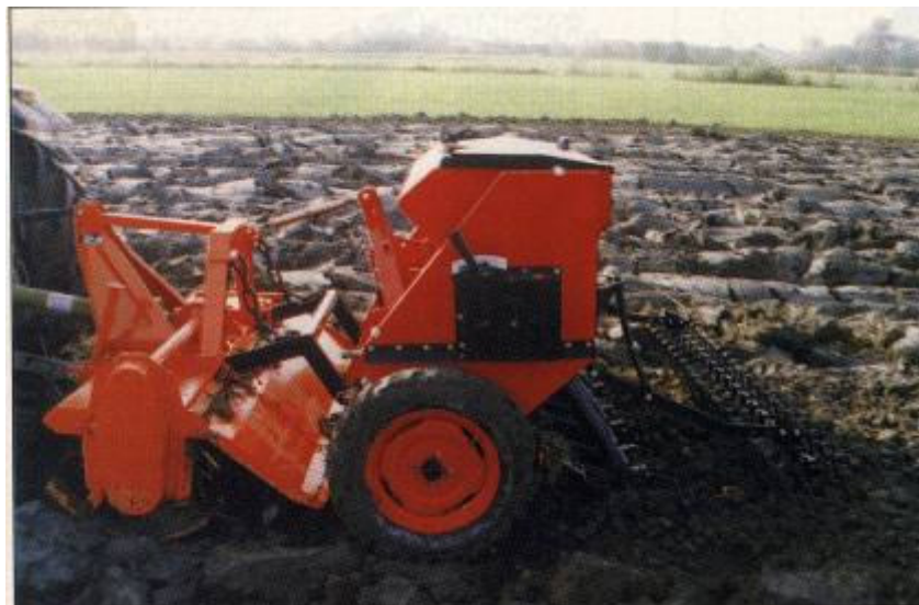
Slika 71: Kombinirani stroj za sočasno obdelavo tal in setev (prekopalnik in sejalnica)
