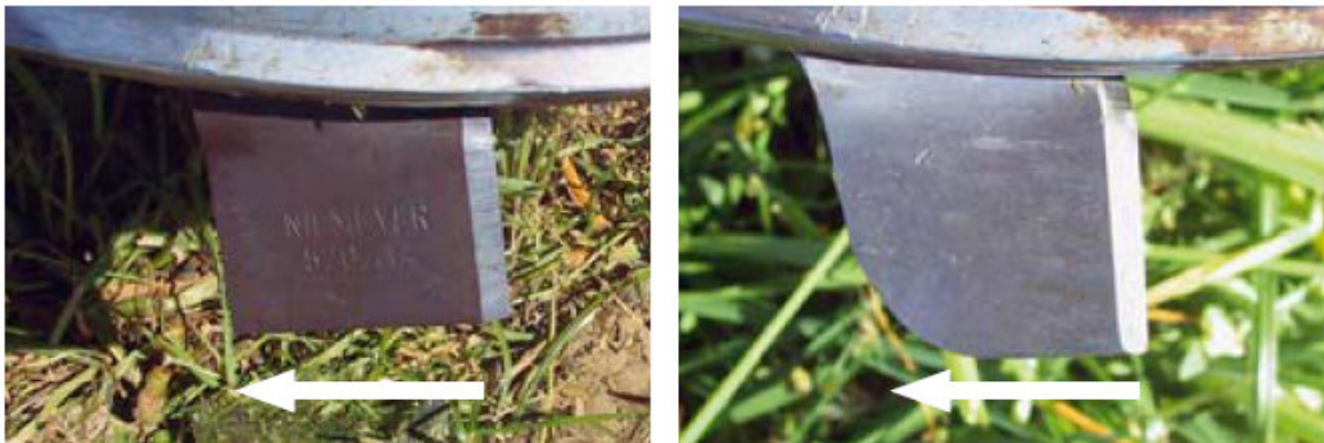
Slika 73: Oster in obrabljen nož na krožni kosilnici
