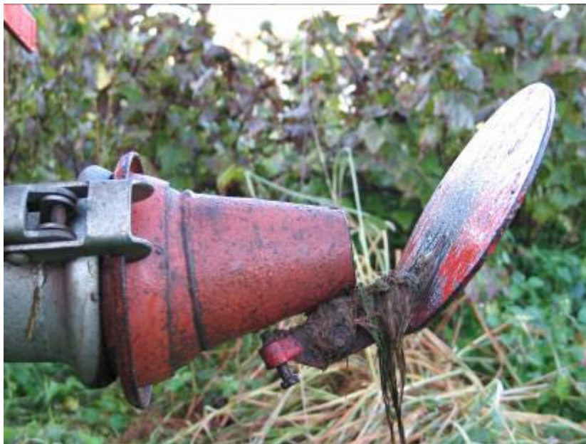
Slika 66: Gnojenje z razpršilno ploščo, pri katerem brizgamo gnojevko visoko v zrak, je z vidika izpustov amonijaka najmanj ugoden način gnojenja.
