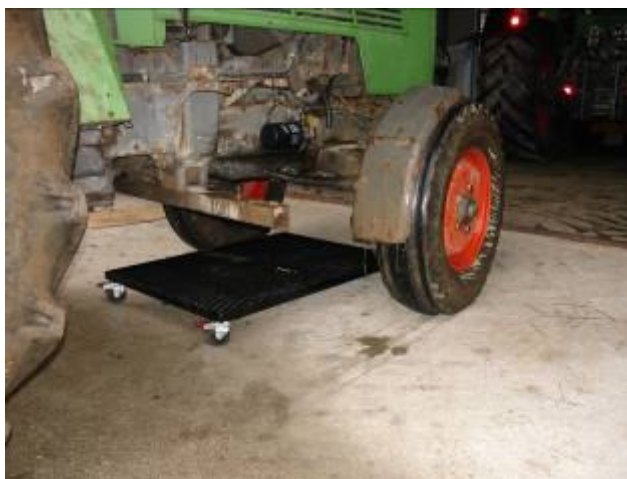
Slika 39: Kovinski ali plastični pladenj, ki ga namestimo pod traktor, preprečuje odtekanje olja v tla. Pladenj mora biti nepropusten za olje in imeti ventil za izpust olja.
