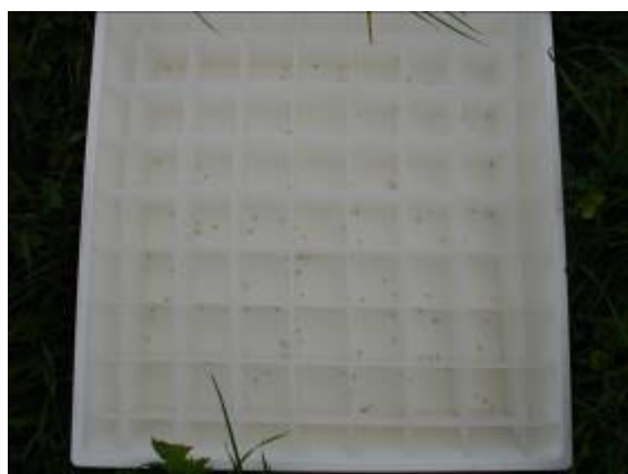
Slika 18: Posode za ugotavljanje slike trosenja so velike 50 x 50 cm. Znotraj so razdeljene s pregradami v majhne kvadratke.
