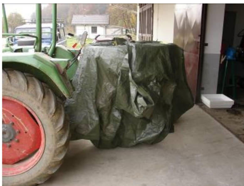
Slika 16: Če nimamo ustreznih nastavkov za ugotavljanje pretoka, si lahko pomagamo tudi drugače, na primer z velikim pregrinjalom v katerega zajamemo mineralno gnojilo.
