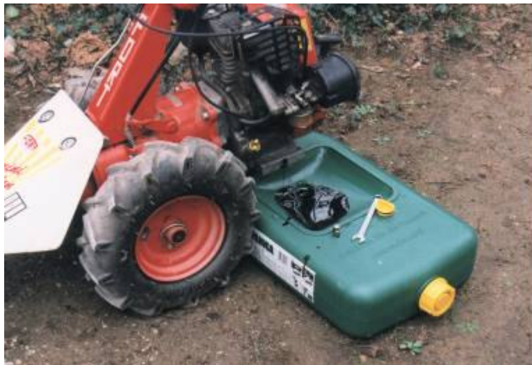
Slika 41: Posodo potisnemo pod motor, odvijemo zamašek na dnu karterja motorja ali menjalnika in izpustimo rabljeno olje.
