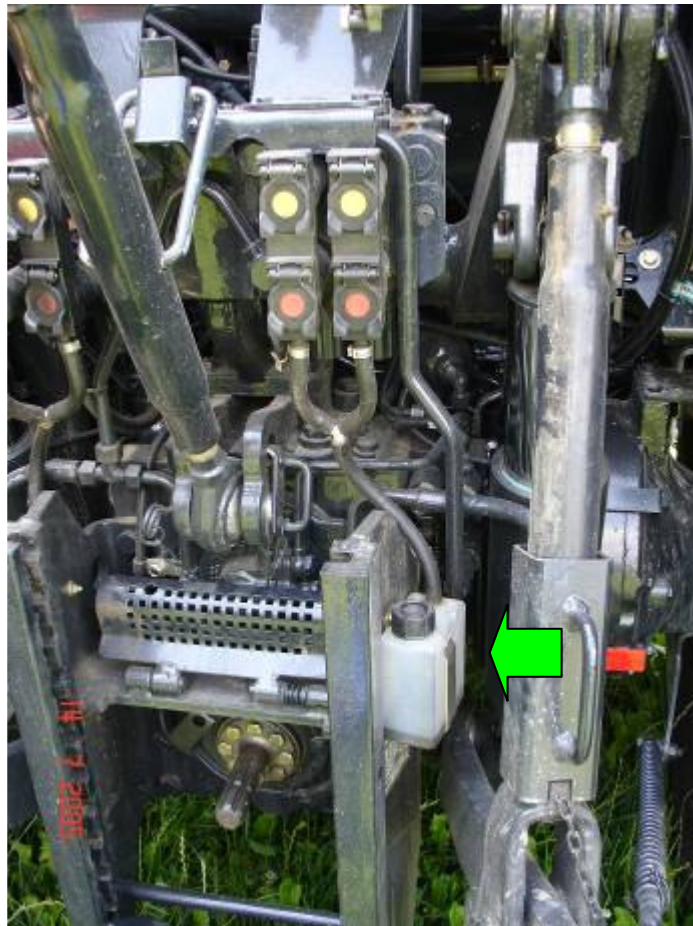
Slika 42: Večja lovilna posodica za olje (označena s puščico) je povezana z hitrimi hidravličnimi priključki sodobnega traktorja.
