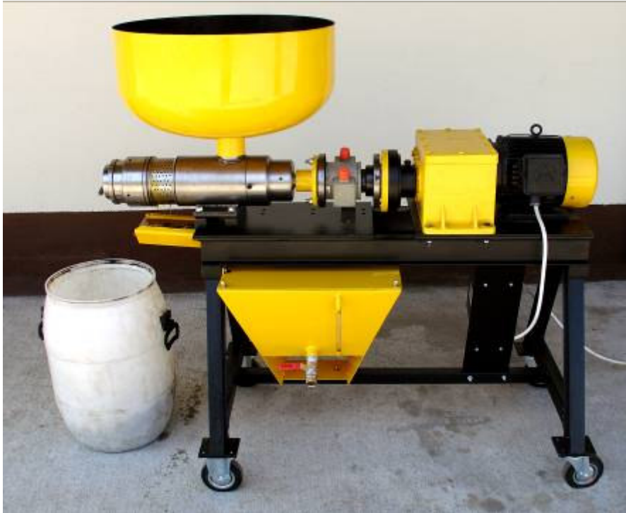
Slika 75: Poskusno pridobivanje olja s postopkom kontinuiranega stiskanja semena oljne ogrščice. Poskusna stiskalnica je bila razvita na Kmetijskem inštitutu Slovenije. Enostavne tehnične rešitve bodo verjetno v prihodnosti omogočile delno samooskrbo kmetij s tekočimi gorivi, kot stranski produkt pa bodo na kmetijah ostale še z beljakovinami bogate oljne pogače.
