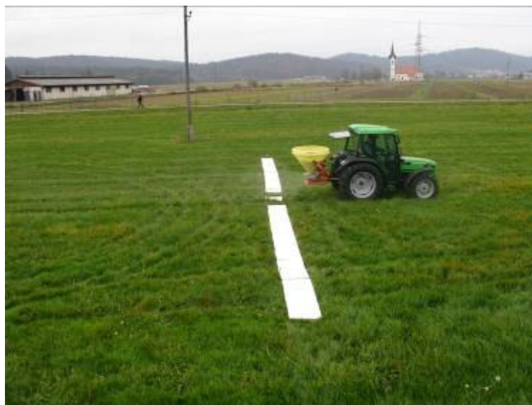
Slika 17: Za ugotavljanje slike trosenja so potrebne posode v katere pade gnojilo med vožnjo
