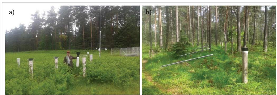
Slika 1: Ploskev IMGE Brdo za merjenje a) padavin na prostem s skrbnikom Tomažem Polajnarjem in b) linija lijev ter žlebičev za merjenje prepuščenih padavin v sestoji. (Foto: Rok Zupin, 2016)
