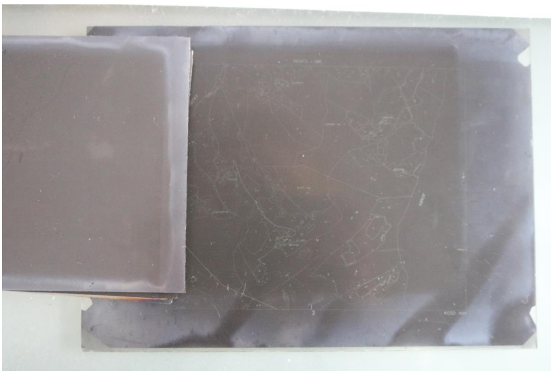
Slika 6: Primer poškodbe srebrovega zrcaljenja
