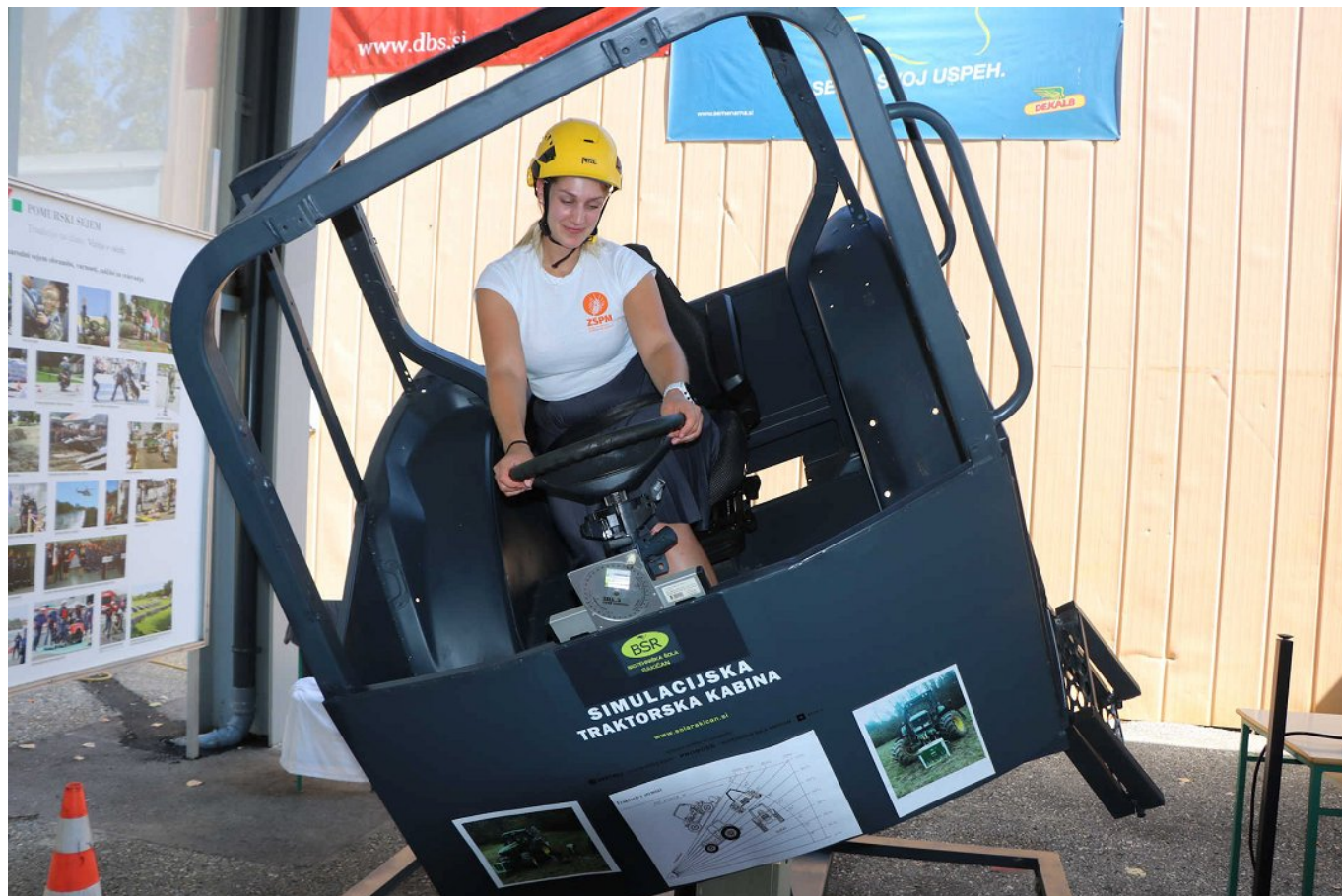
Slika 3: O pomenu in nujnosti uporabe varnostnih pasov se lahko prepričamo v simulatorju prevračanja / nagibni kabini, kjer na lastni koži spoznamo, kako nas varnostni pas zadrži na sedežu in ne pademo iz vozila (kabine traktorja) in posledično pod vozilo, pa tudi ne udarimo v dele vozila. Nagibna kabina je od 1.1.2026 obvezna oprema izvajalcev usposabljanja za varno delo s traktorji in traktorskimi priključki za pridobitev voznškega dovoljenja kategorije F.
