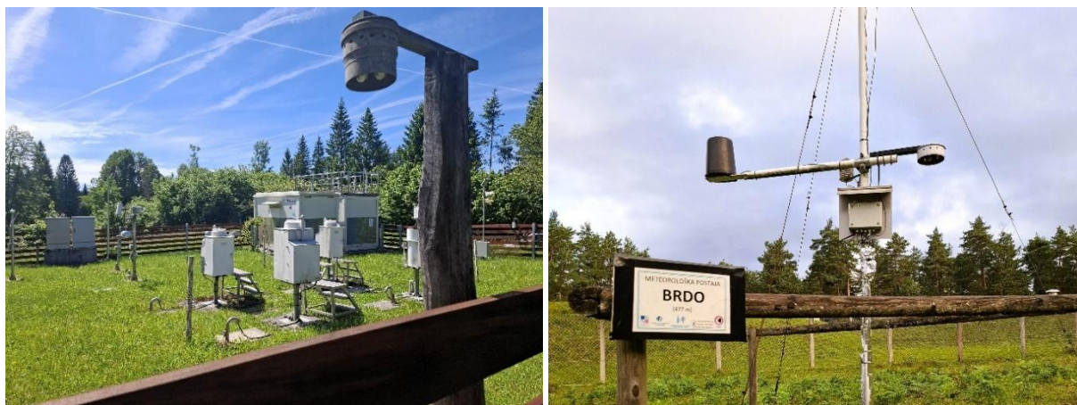
Slika 84: Kontrolne meritve ozona z difuzivnimi vzorčevalniki na merilni postaji ARSO v Ljubljani (april 2022) – levo ter meritve ozona z difuzivnimi – pasivnimi vzorčevalniki na meteoroloških postajah ob IMGE ploskvah. Ploskev Brdo pri Kranju (Foto: M. Rupel)
