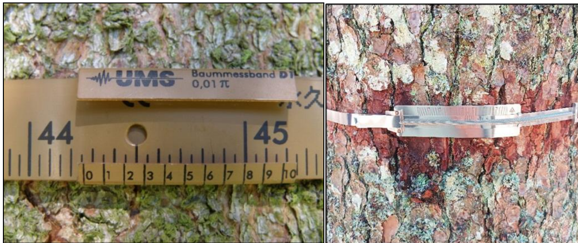
Slika 39: Spremembe v premeru debla odčitavamo na desetinko milimetra natančno, kar omogoča nonijska skala. Na sliki levo je ročni dendrometer nemškega proizvajalca UMS München, ki kaže absolutne spremembe premera, na sliki desno pa ročni dendrometer češkega proizvajalca EMS Brno, ki kaže spremembo obsega, premer pa moramo izmeriti posebej.
