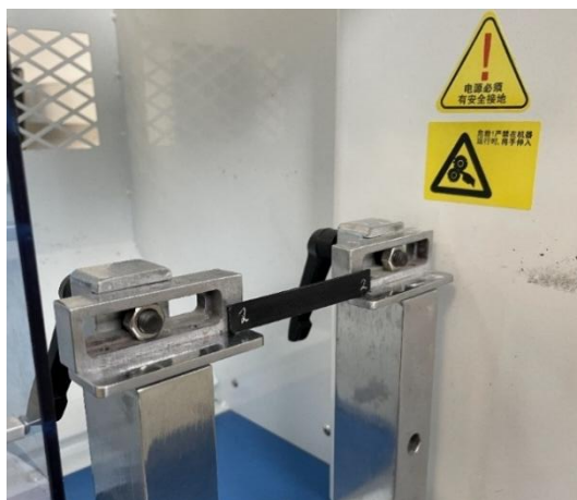
Slika 15: Vzorec brez zareze
