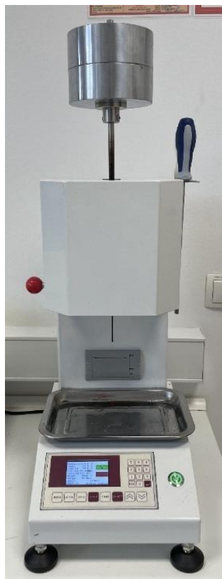
Slika 20: Naprava LIYI MFI LY-RR
