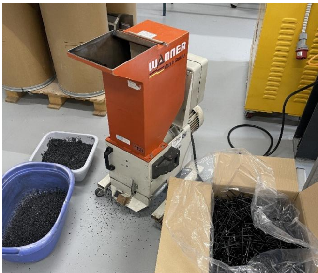
Slika 6: Mlin za mletje termoplastov Wanner
