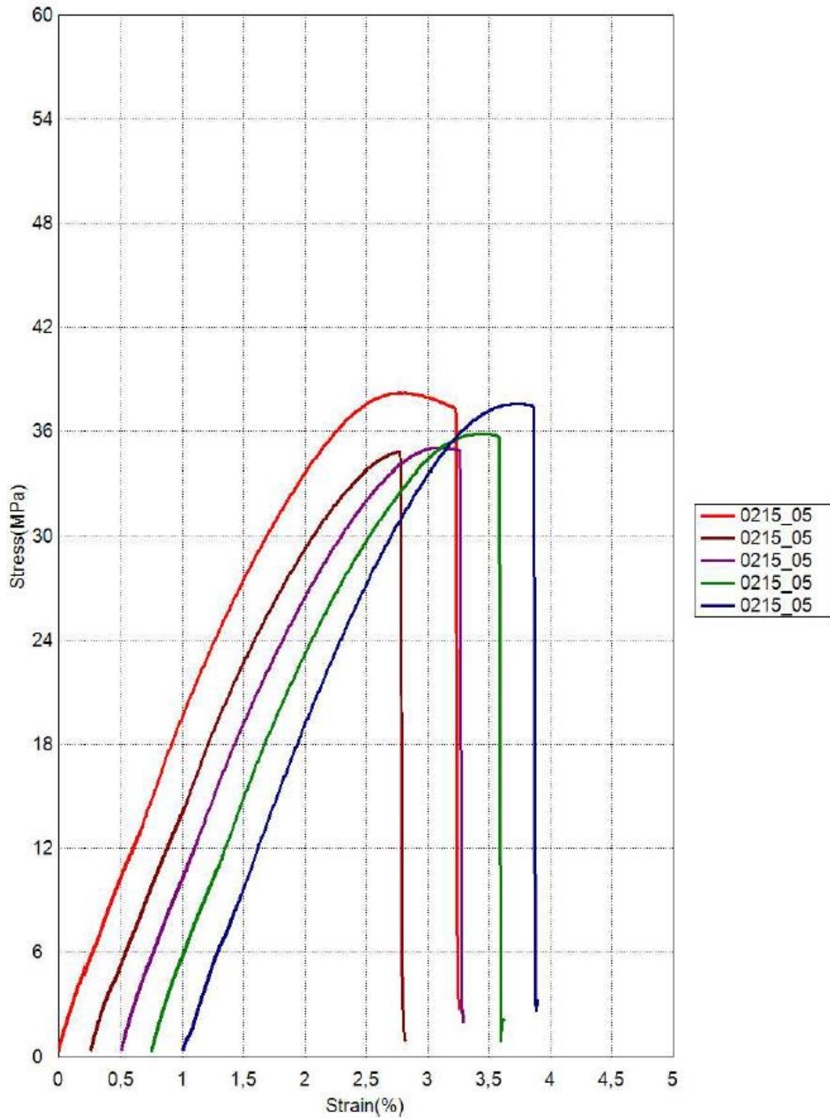
Slika 38: Graf nateznega testa za vzorec 822_2023_0215_05
