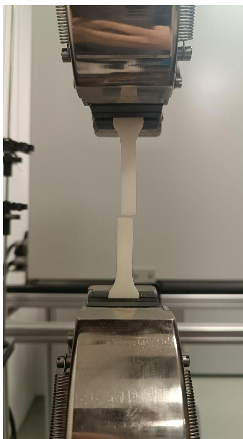
Slika 13: Natezni preizkus enega izmed vzorcev PLA/PVA 70/30
