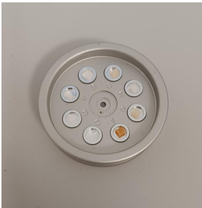
Slika 14: Tehtani vzorci za analizo DSC
