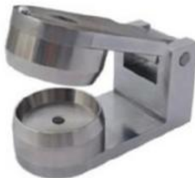
Slika 11: Orodje za ugrizni test, določeno v ameriškem zveznem zakonu 16CFR1500.51 [55]
