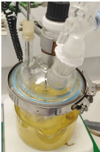
Slika 8: Sublimirani amin na vrhu vratu reaktorja
