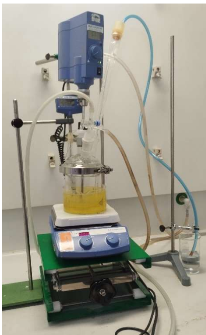
Slika 7: Eksperimentalna postavitve za aminolizo
