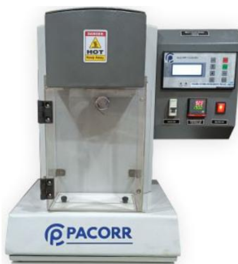
Slika 6: Polavtomatski tester pretoka taline [13]
