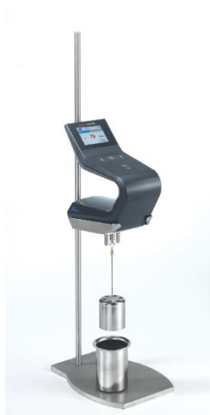
Slika 3: Sodobni rotacijski viskozimeter [2]
