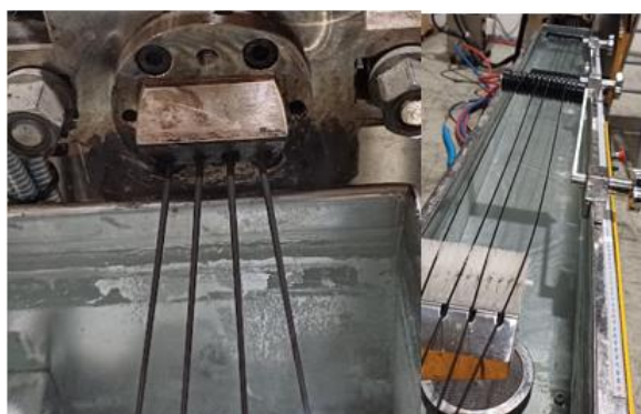
Slika 11: Šoba kompavnderja (levo) in vodna kopel (desno)
