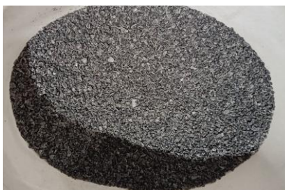
Slika 8: Pripravljena mešanica PA6/ 30 GF + reciklat
