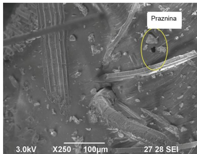
Slika 12: Nastanek praznine kot posledica ujete vlage v polimernem kompozitu UPE/metil etil keton peroksidi (MEKP)/bazaltna vlakna [41]
