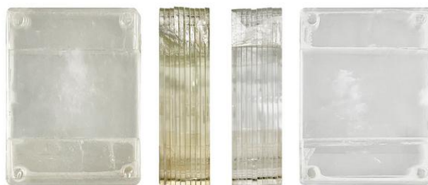
Slika 7: Sprememba barve zaradi razgradnje polimernega materiala na levi in barva polimernega materiala po odpravi defekta na desni [34]
