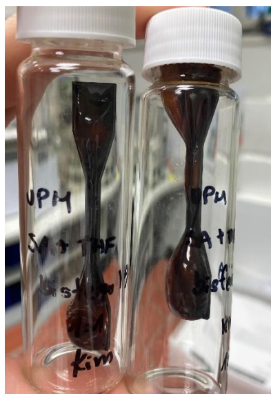
Slika 6: Testne epruvete za vzorec UPM_F_MIX – ARALDITE® LY 564_50 %
