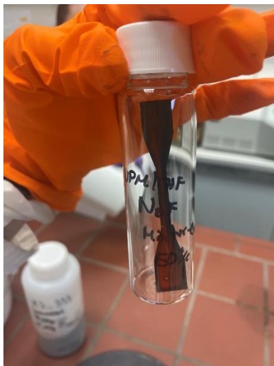
Slika 7: Testne epruvete za vzorec UPM_NoF_ MIX – ARALDITE® LY 564_50 %
