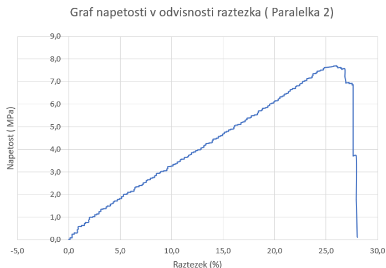
Slika 16: Graf napetosti v odvisnosti od raztezka za vzorec funkcionaliziranega lignina UPM z dodatkom MIX – ARALDITE® LY 564 – paralelka 2
