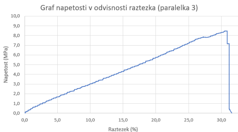
Slika 17: Graf napetosti v odvisnosti od raztezka za vzorec funkcionaliziranega lignina UPM z dodatkom MIX – ARALDITE® LY 564 – paralelka 3
