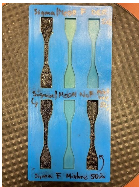
Slika 10: Gumijasti kalupi za oblikovanje testnih epruvet
