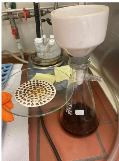
Slika 9: Vakuumsko filtriranje raztopljenega lignina
