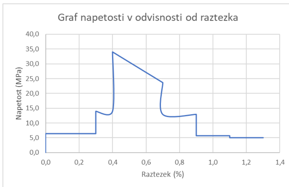
Slika 18: Graf napetosti v odvisnosti od raztezka za vzorec nefunkcionaliziranega lignina UPM z dodatkom D.E.R 332
