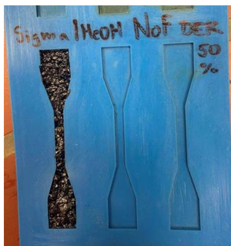
Slika 12: Testna epruveta, pripravljena iz nefunkcionaliziranega lignina Sigma.
