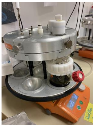
Slika 5: Večpozicijski grelni vrtiljak z magnetnim mešanjem
