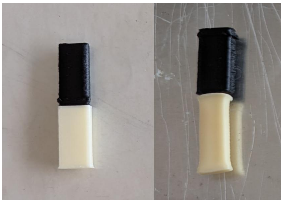
Slika 21: Epruveta za test adhezije pred toplotno obdelavo (levo) in po toplotni obdelavi (desno) štirih ur pri temperaturi 150 °C in osmih ur pri temperaturi 120 °C
