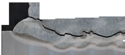
Slika 3. Razpoke v reparaturnih zvarih.
