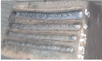
Slika 15. Testiranje reparaturnih zvarov. Fig. 15. Testing repair welds.
