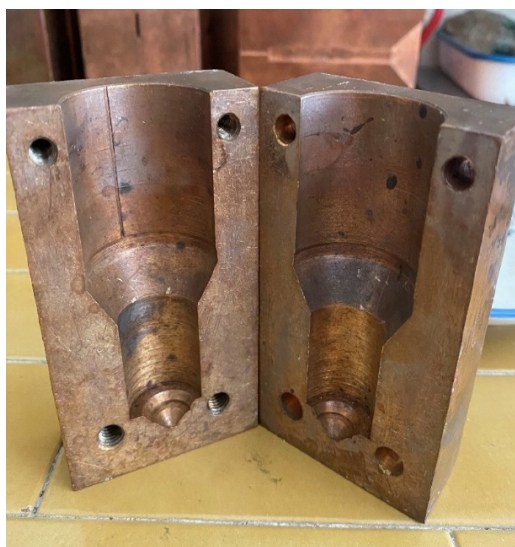
Slika 1. Bakrena kokila, uporabljena v procesu ulivanja.
