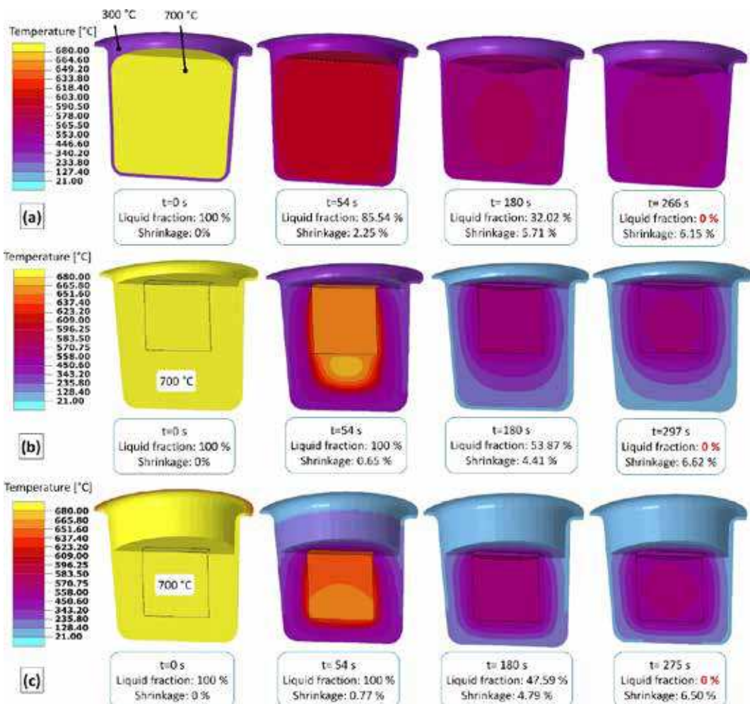
Slika 6. Prečni prerez porazdelitve temperature glede na simulacije strjevanja (a) tradicionalnih in (b,c) pretaljenih vzorcev RPT v različnih fazah procesa strjevanja. (b) predstavlja primer, ko je bilo za talilno sredstvo uporabljenih 55 g in (c), ko je bilo uporabljenih 30 g kremenčevega peska
