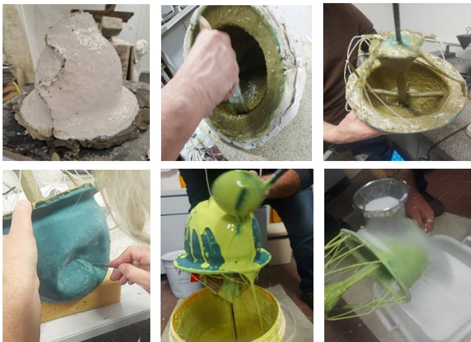
Slika 3. Silikonska forma (zgoraj levo), nanašanje slojev voska na silikonsko formo (zgoraj na sredini), izdelan ulivni sistem z zračniki (zgoraj desno), cizeliranje voska (spodaj levo), pomakanje in polivanje voščenega modela s keramično suspenzijo (spodaj na sredini) in posipanje s kremenčevim peskom (spodaj desno)
