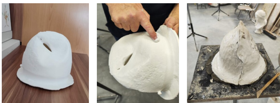
Slika 2. Natisnjena model čelade (levo), glajenje modela (sredina) in silikonska forma iz dveh delov (desno)
