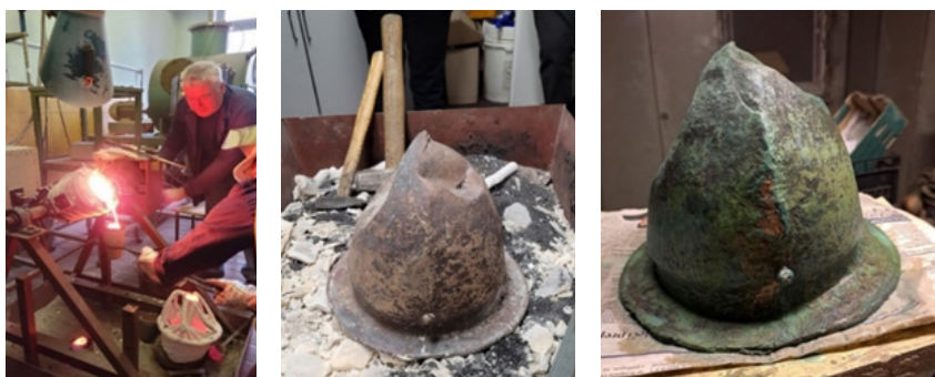
Slika 4. Prelivanje ostanka taline po ulivanju čelade (levo), čelada po ulivanju (na sredini), patinirana čelada (desno)
