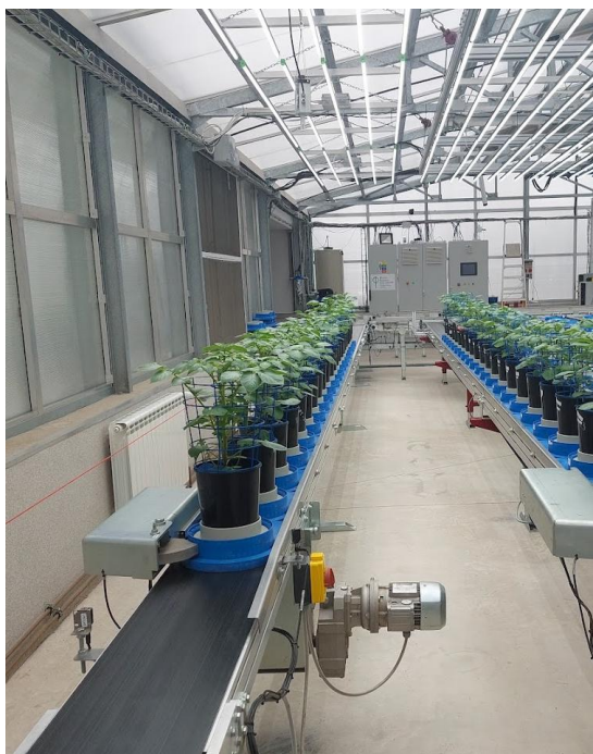
Avtomatsko zalivanje in dostava rastlin v fenotipizacijsko komoro za zajemanje fotografij
