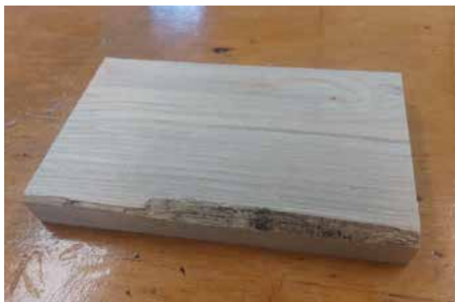
Slika 2: Poškodovan les zaradi lubadarja in obarvan z glivami modrivkami (Foto: Irinej Curk in Matevž Plevnik)
