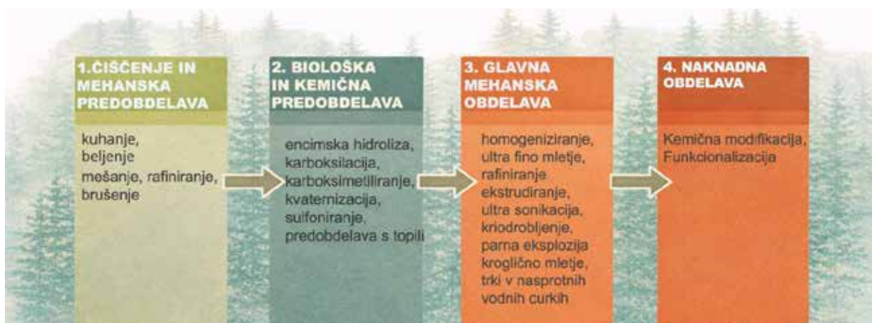
Slika 2: Shema proizvodnega procesa pridobivanja CNF
