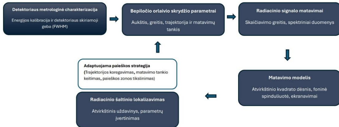
1 pav. Metodologinis modelis radioaktyviojo šaltinio aptikimui ir lokalizavimui naudojant bepiločius orlaivius
