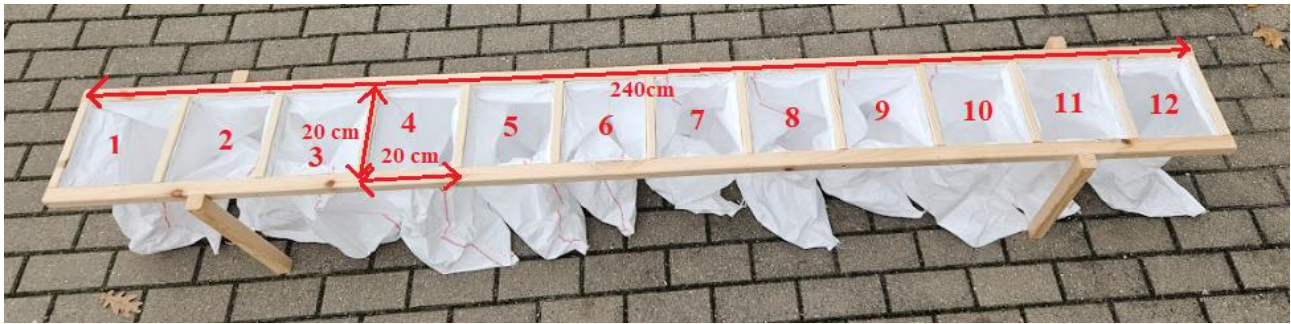
4 pav. Surinkimo sistemos komponentas – rėmelis su maišeliais
