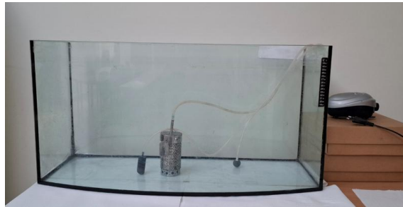
1 pav. Tyrimo indas su bioreaktoriumi „Chem5“. 1 – biorektorius; 2 – difuzoriai; 3 – orapūtė
