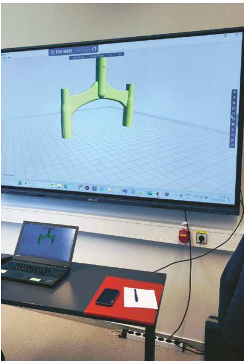
Postopek 3D-skeniranja omogoča generiranje gostih oblakov točk, ki jih je možno z nadaljnjo obdelavo pretvoriti v točkovne mreže ali parametrične CAD modele.
