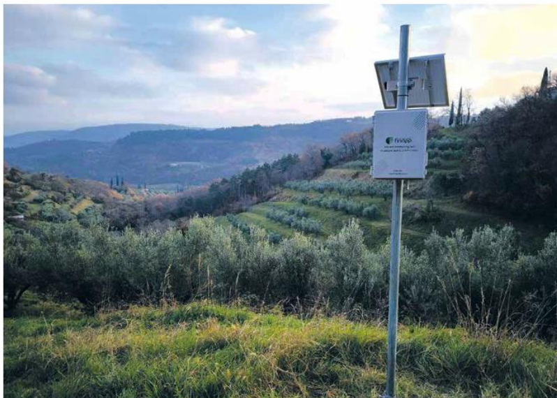
Merjenje vsebnosti vode v tleh z metodo zaznavanja nevtronov je eden izmed naprednih pristopov upravljanja vodnih virov, ki ga uporabljajo na kopskem demonstracijskem poligonu v okviru projekta LIFE4ADAPT. FOTO: Žiga Švegelj
