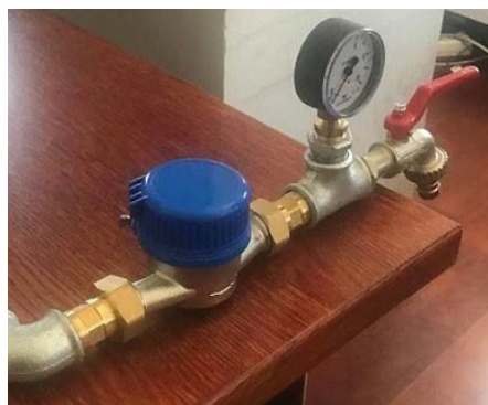
Slika 11. Merilna oprema izpustnega mesta za nadzorovano odvajanje ujete podzemne vode
