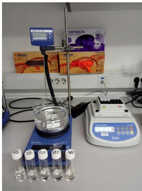
Slika 8: Oljna kopel z DES in termični stresalnik
