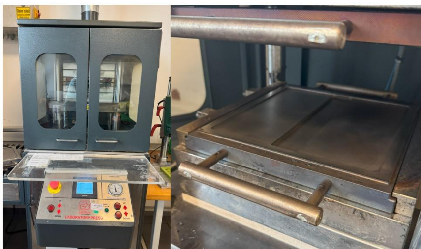
Slika 35: Laboratorijska stiskalnica Gibitre instruments S.r.l. in orodje za pripravo testnih ploščic
