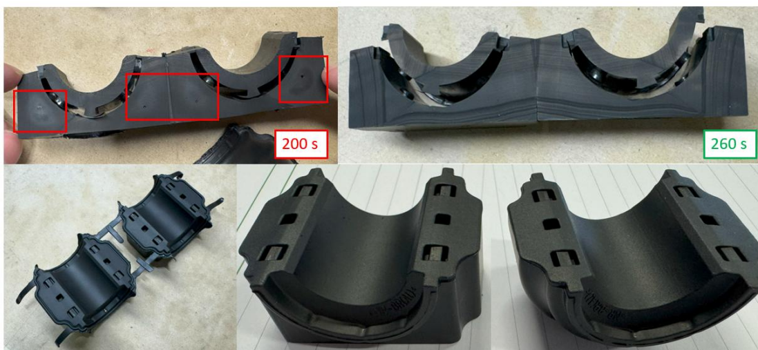
Slika 53: Zgornji in spodnji del gumene puše (NR/EPDM zmes), prikaz podaljšanja vulkanizacijskega cikla
