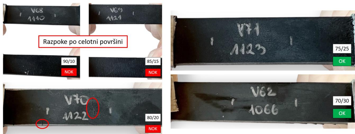
Slika 52: Rezultati ozonskega testa - določitev minimalnega deleža EPDM
