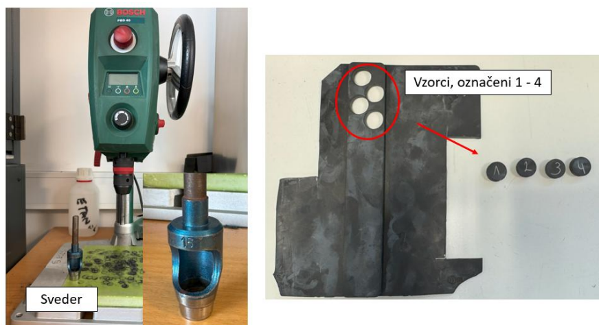
Slika 42: Priprava vzorcev za meritve abrazivne odpornosti
