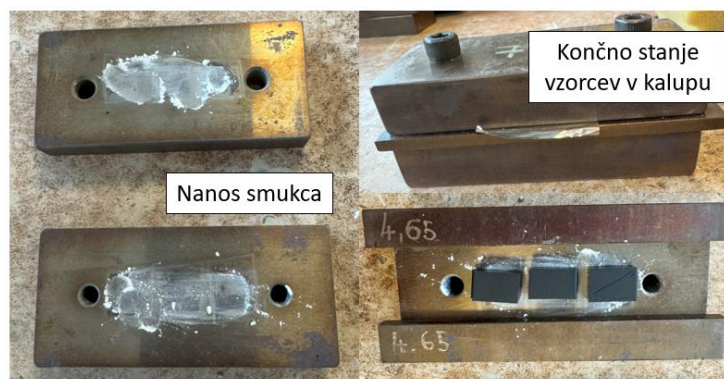
Slika 40: Nanos smukca in vpetje vzorcev za izvedbo DVR meritev
