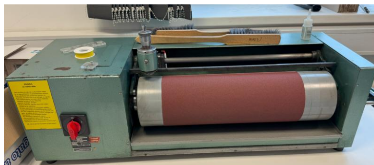
Slika 41: Brusilni in polirni stroj TIRA
