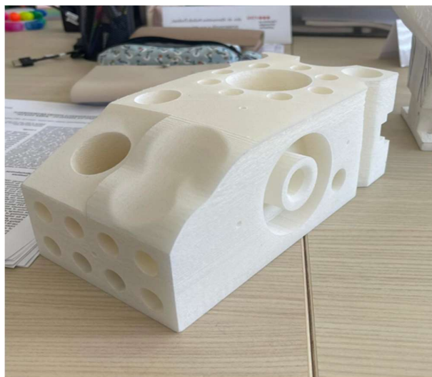
Slika 31: Končan natisnjen 3D kos s tehniko SLS
