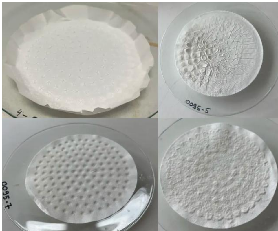
Slika 17: Nerazpadli delci vzorca 4 (levo zgoraj), vzorca 5 (desno zgoraj), vzorca 6 (desno spodaj) in vzorca 7 (levo spodaj)
