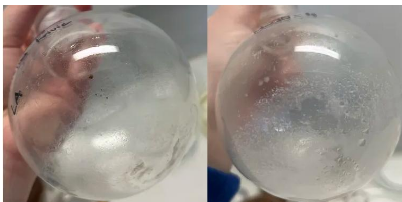
Slika 18: Ostanek delcev vzorca 1 (levo) in vzorca 4 (desno) po uporabi rotavaporja
