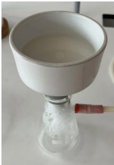
Slika 16: Postopek vakuumske filtracije
