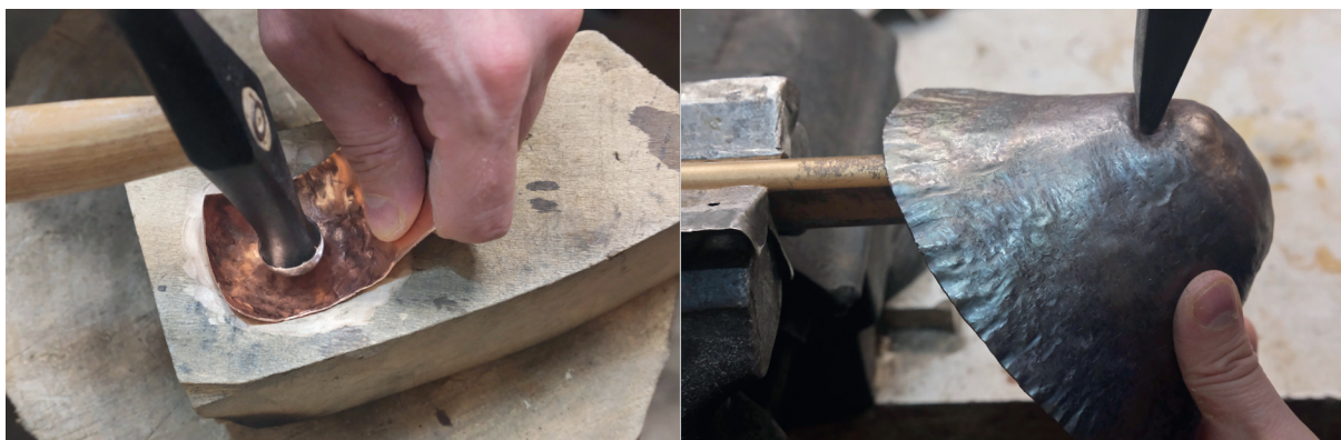
Sl. 15: Kovanje bakrene pločevine v vbočeno obliko na vdolbeni matrici–levo in dviganje stožčastega polizdelka na okroglem trnu–desno (foto: Nataša Nemeček).
