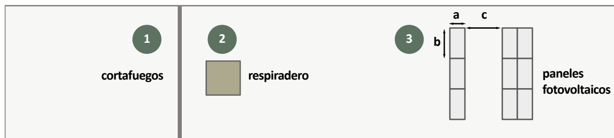
Figura 8: Vista superior de una estructura de cubierta con (1) cortafuegos, (2) respiradero y (3) paneles fotovoltaicos. El respiradero también debe cumplir con las normas nacionales respecto de la distancia al cortafuegos.
