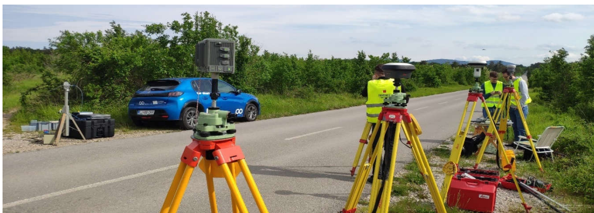
Slika 10: Spremljanje odziva sprejemnikov GNSS (spredaj) na namerne motnje z motilnikom Keysight (v ozadju); Črnotiče, 15. 5. 2024.
