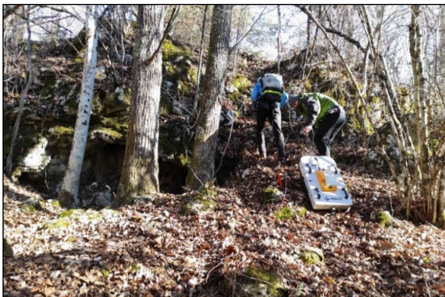
Slika 8 – GPR meritve GP1 profila nad jamo Šimčev spodmol (Foto: A. Švara).
