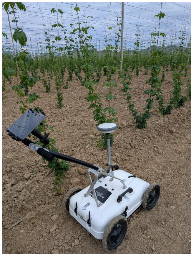
Slika 2: Georadarska naprava v hmeljišču (Foto: J. Ferlin)
