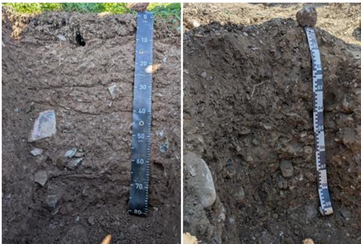
Slika 1: Dva primera skeletnih tal. Na levi je prevladujoča ploščata oblika skeleta, na desni pa zaobljena (Foto: J. Ferlin).
