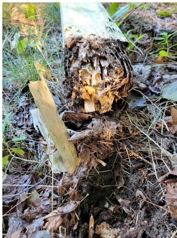
Slika 4: Poškodbe termitov na neobdelanem kolu iz rdečega bora, nameščenim v kovinski čevlji (levo), in poškodba kontrolnega neimpregniranega kola bora v neposrednem stiku s tlemi po šestih letih izpostavitve (desno)
